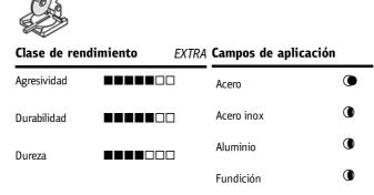
Ventajas: Buena estabilidad de corte - Buenos tiempos de corte con una larga vida útil - Recomendado para todos los perfiles normales - Puede ser utilizada con todas las máquinas de corte (sierra circular) en el comercio y la industria
